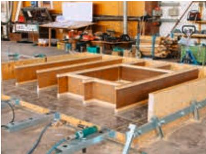
Les poutres en I STEICO*wall* forment l'ossature des murs. Le cadre est en lami-bois STEICO *LVL R*.
