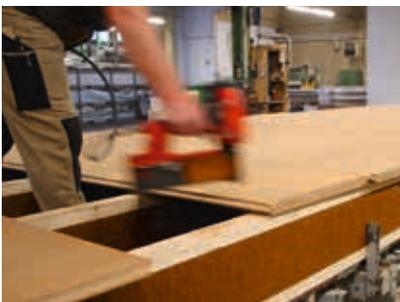
Le tout est recouvert d'un panneau de sous-toiture en STEICOuniversal pour la toiture, ou d'un panneau isolant support d'enduit STEICOprotect pour les murs.
