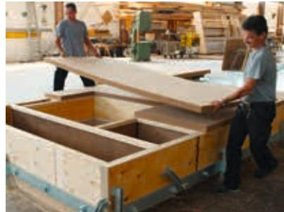
Parement extérieur avec le panneau support d'enduit STEICO*protect*. Une première couche d'enduit a été posée lors de la préfabrication en atelier pour protéger le mur des intempéries.
